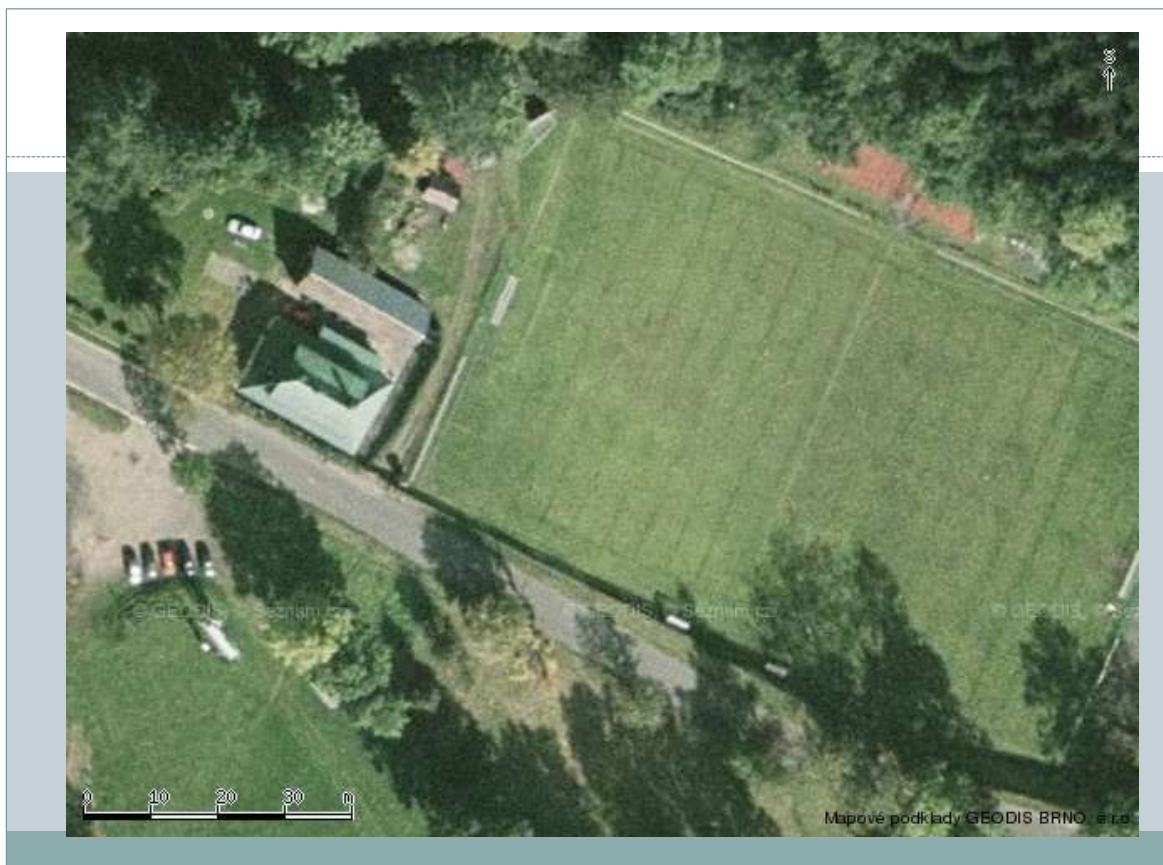
Obrázek 3. Satelitní snímek fotbalového hřiště FK Rokytnice n/J. Tmavé pruhy ukazují kde je položeno drenážní potrubí. Přestože celá plocha dostává stejnou péči, tak tráva nad potrubím je zdravější a má i silnější kořenový systém. Dostává totiž něco, co tráva mezi potrubím nemá. Perforované drenážní potrubí, které je chybně položeno příliš blízko povrchu (okolo 15cm), přivádí vzduch do kořenového
